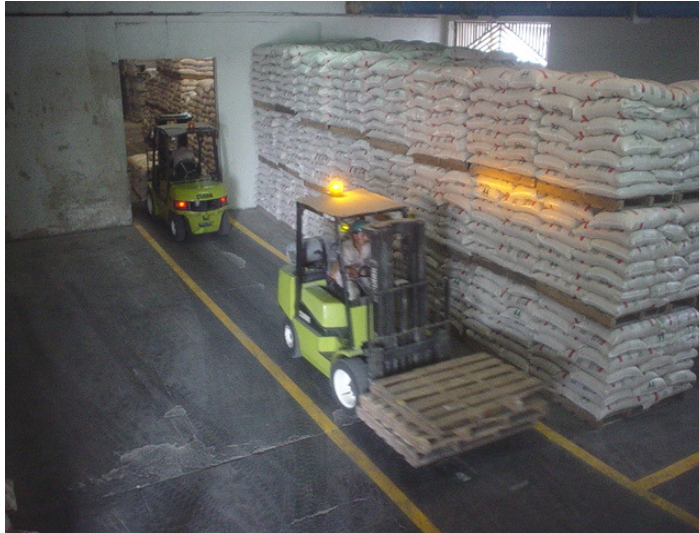
Figura 50: Circulación de los montacargas obedeciendo la señalización implementada en la bodega de producto terminado.
