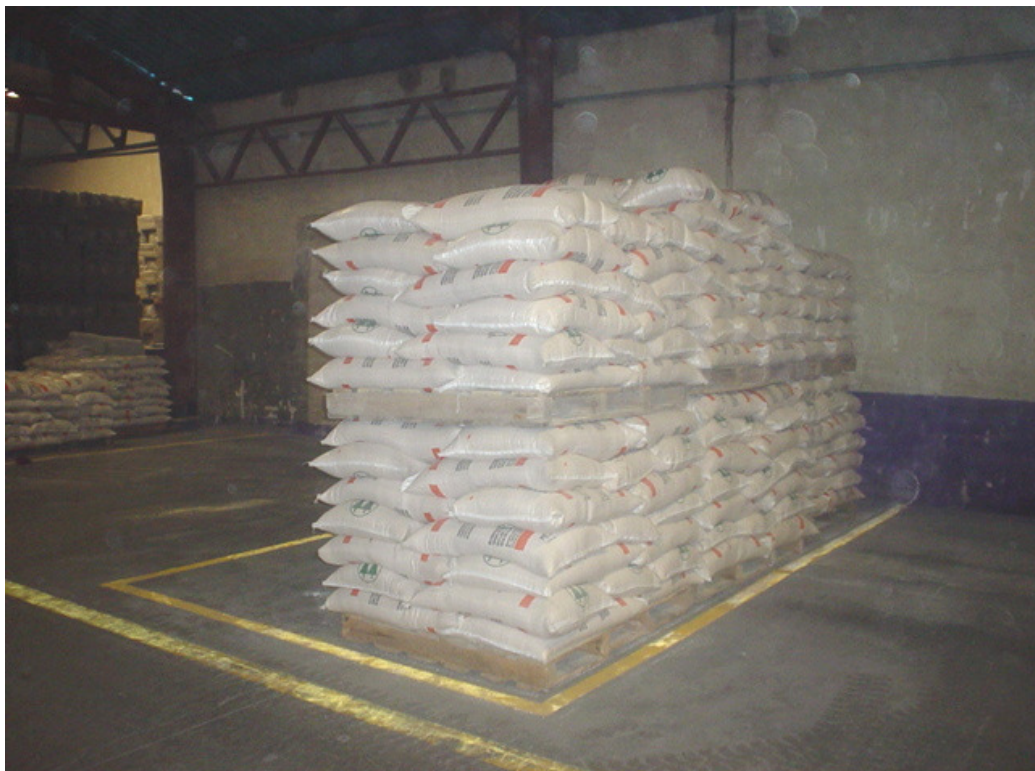
Figura 45: Delimitación de espacios para estibamiento de sacos en bodega de producto terminado.
