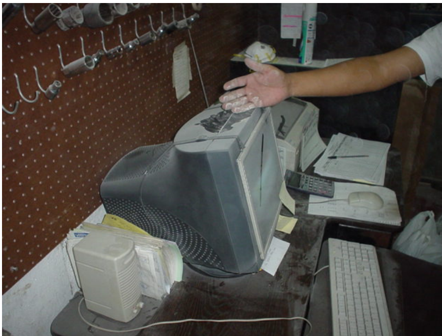
Figura 33: Acumulación de polvos en equipos electrónicos.
