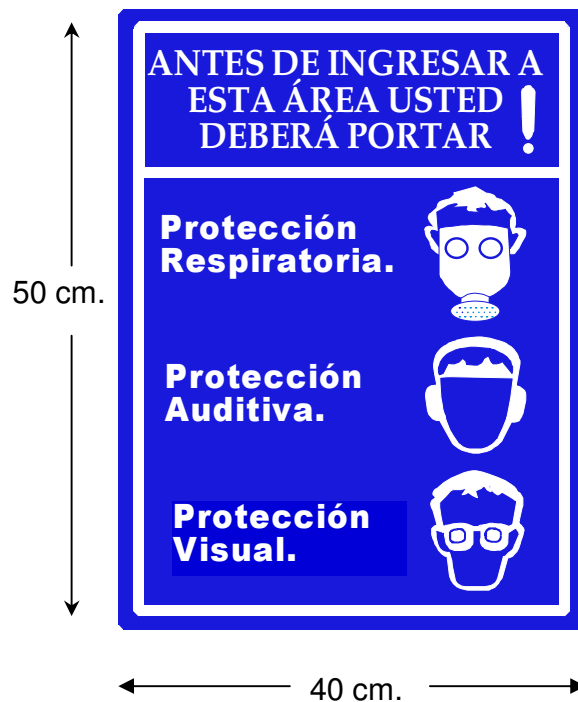
Figura 41: Diseño de señal de prevención área de pre-mezcla.
