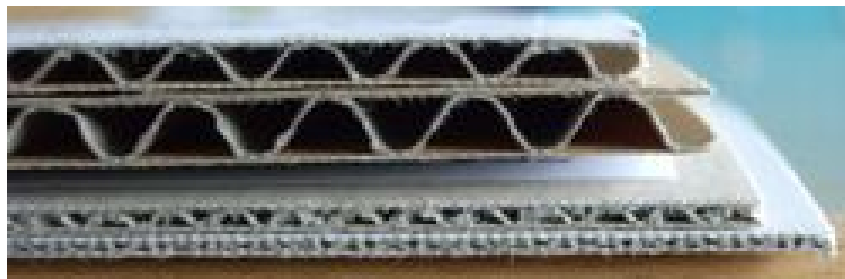
Figura 6 Planchas de cartón ondulado de diferentes grosores
