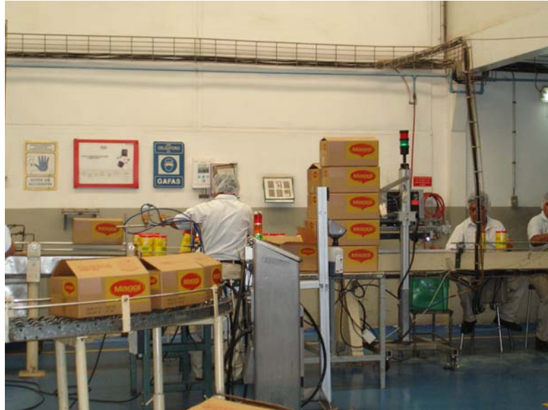
Figura 35. Colocación de productos culinarios envasados en frascos en cajas de cartón
