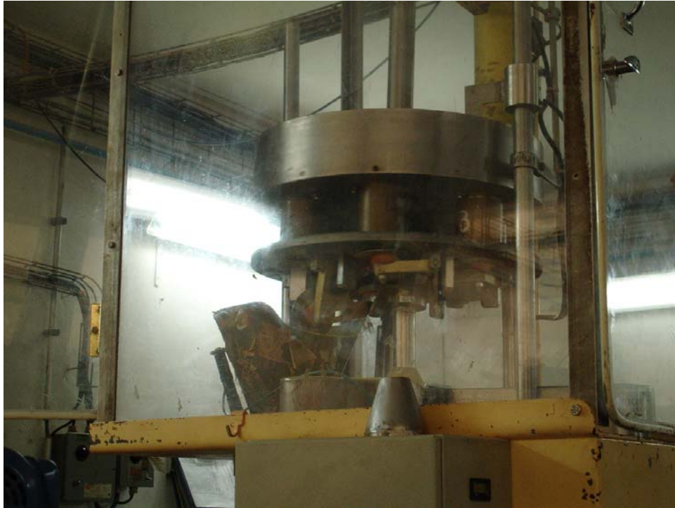
Figura 36. Parte superior de llenadora de frascos
