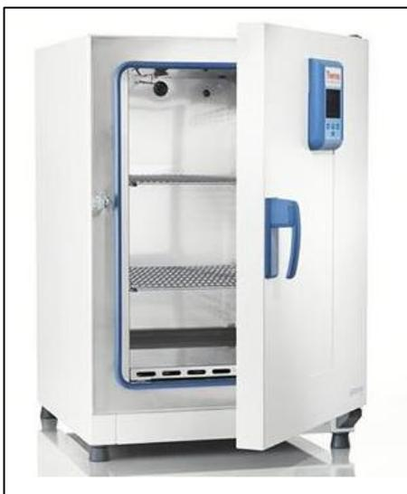
Fuente: Equipos y Laboratorio. *Estufa de secado*.
