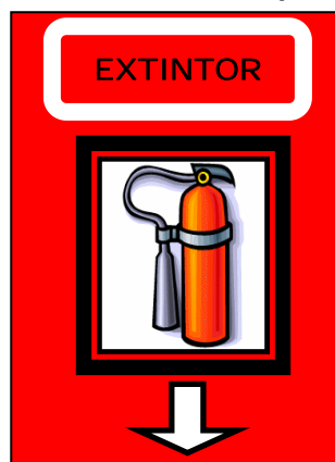
Figura 49. Señalización para extintor
