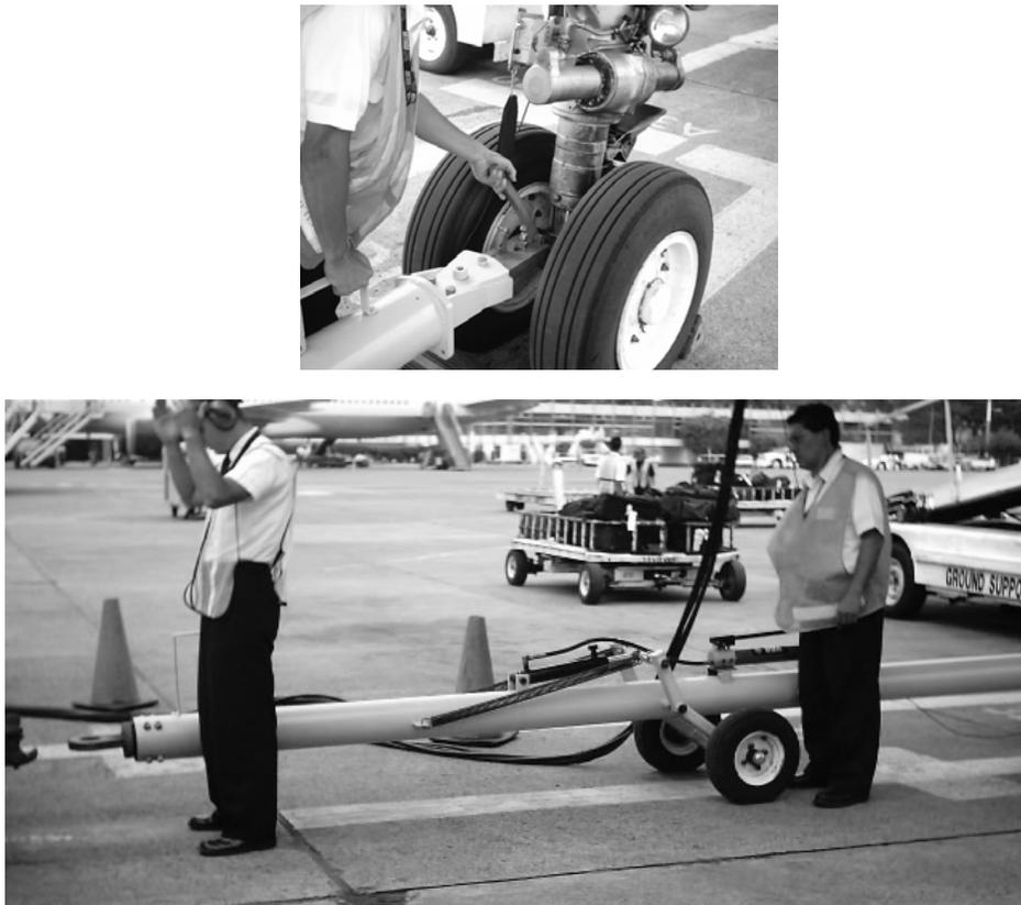
**Figura 19. Colocación de la barra de retroempuje en el remolque.**
