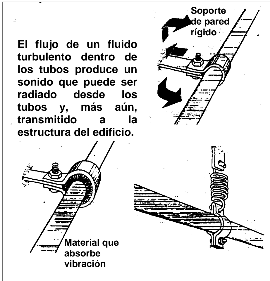
Figura 7. Reducción del ruido disminuyendo su transmisión, a través del aire
