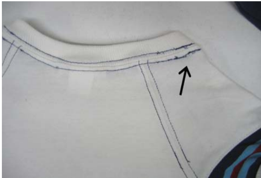
Figura 33: Costuras de hilo de contraste mal empalmadas.
