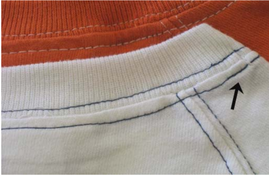
Figura 34. Empalme correcto hilos de contraste.
