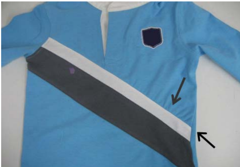
Figura 32. Fruncimiento en el piecing del delantero.
