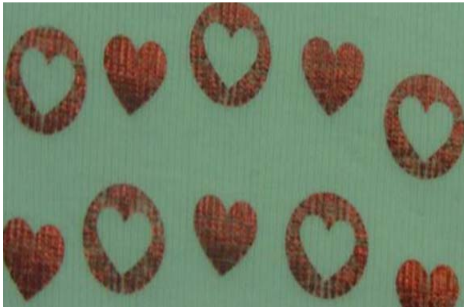
Figura 38. Deterioro el estampado después de la primera lavada.
