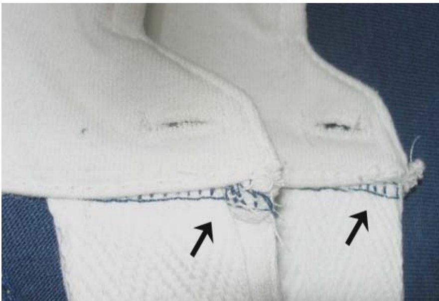
Figura 35. Costuras internas visibles en la base del cuello
