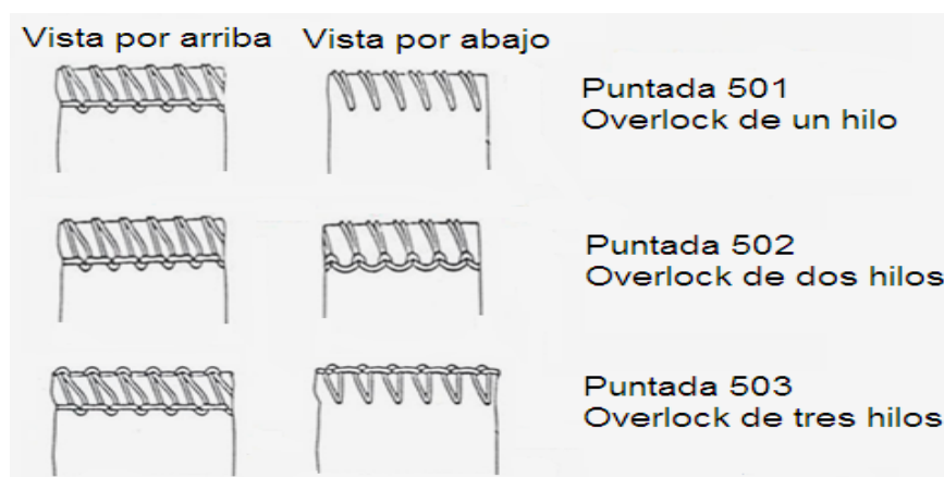
Figura 11. Puntadas Overlock de uno y dos hilos.
