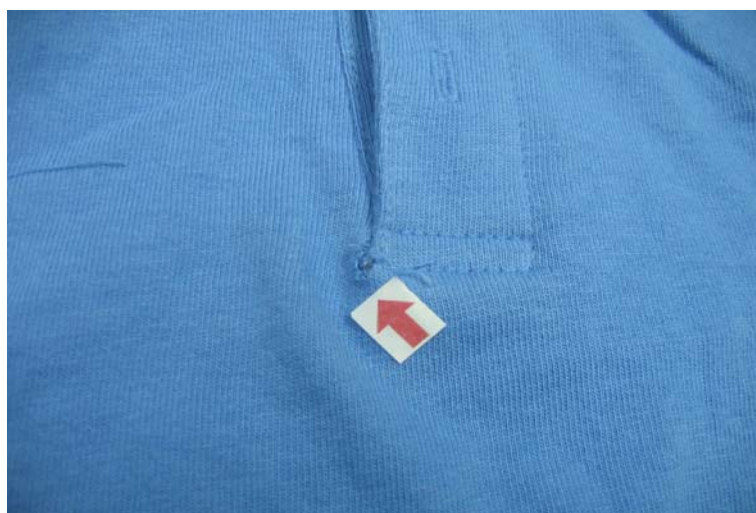
Figura 31. Agujero en la base del placket .
