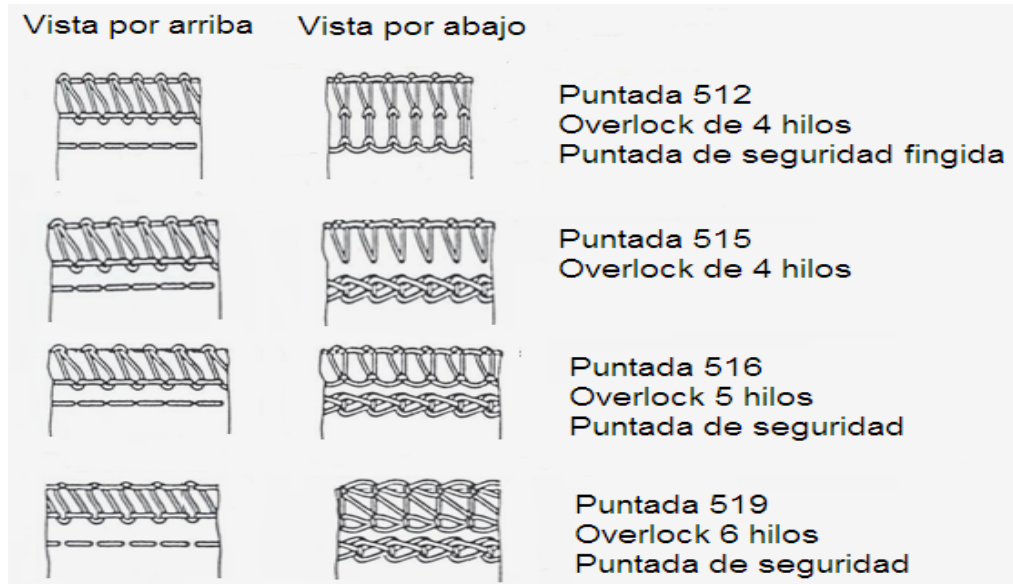
Figura 12. Puntadas Overlock de 4,5 y 6 hilos.
