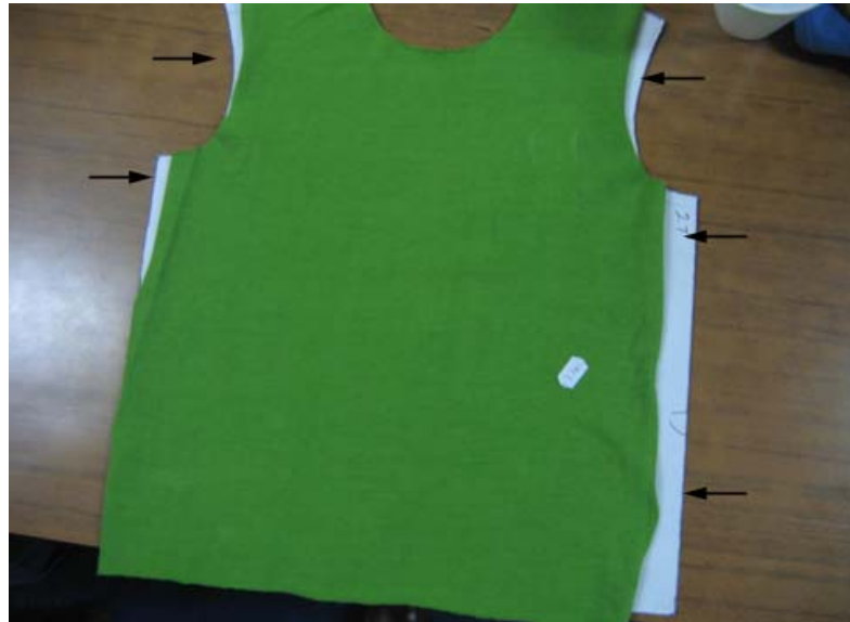
Figura 28. Delantero defectuoso por encogimiento.
