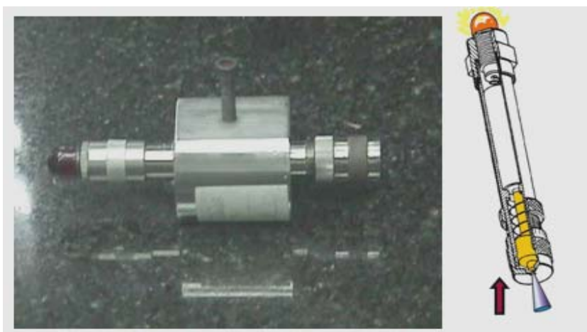
Figura 26. Equipo para medir si la punta es peligrosa en un artículo para niños.
