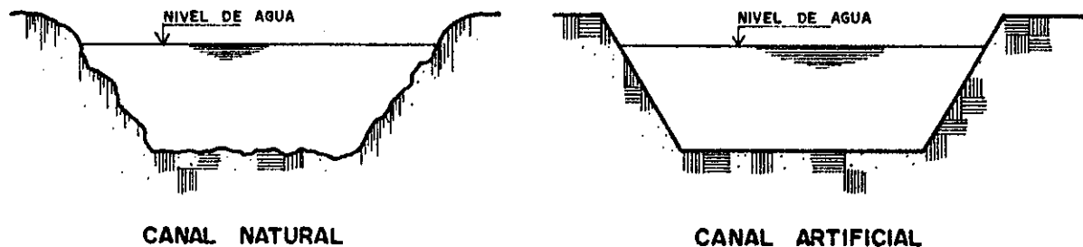
Figura 1.1.2 Ejemplos de canal abierto
