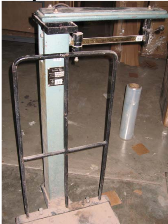
Balanza mecánica con capacidad de 200 libras y precisión de 2 libras.
