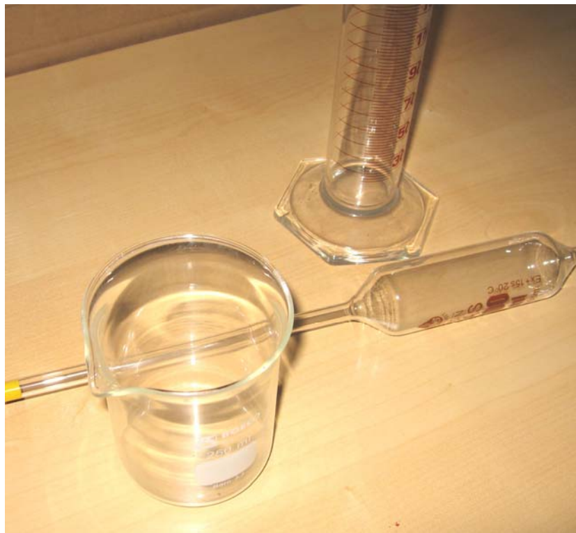
De arriba hacia abajo la imagen muestra, una probeta, una pipeta y un beker.
