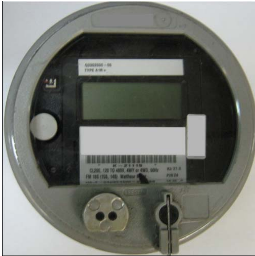
Figura 10. Medidor de energía eléctrica tipo Electrónico
