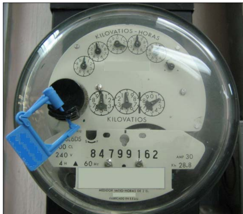
Figura 5. Medidor de energía eléctrica de Vatios hora y Demandómetro
