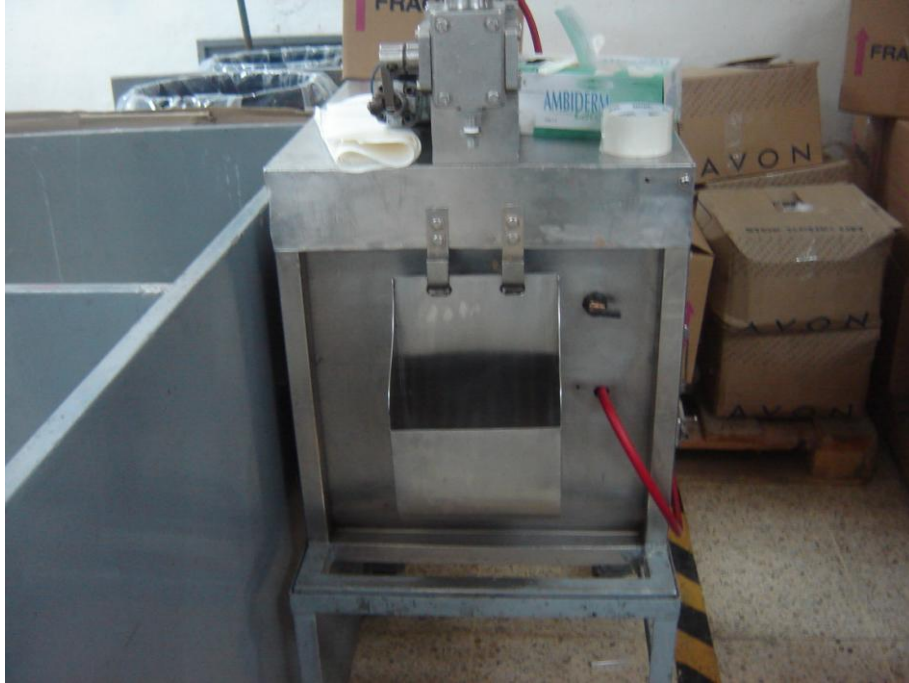
Figura 22. Bandeja instalada en llenadora de mono pistón
