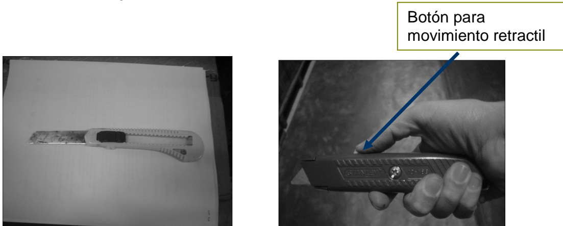
Figura 46. Cuchillas utilizadas lado izquierdo y cuchillas retractiles que se implementaron lado derecho
