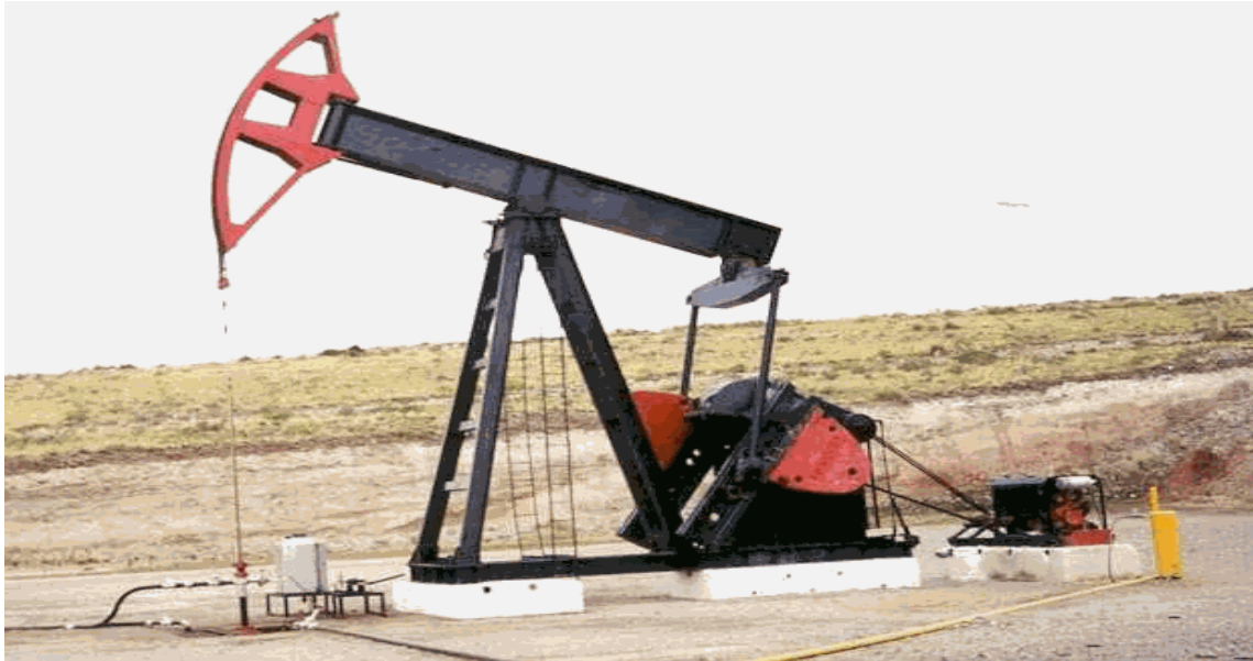
Figura 3: Unidad superficial de bombeo mecánico
