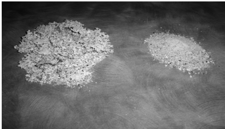
Figura 31. Muestras del mineral perlita, a la derecha se encuentra en bruto y a la izquierda se encuentra ya inflada
