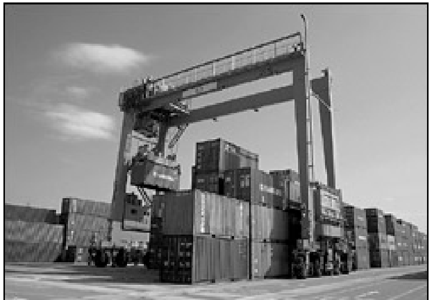
Figura 20. Grúa pórtico de patio
