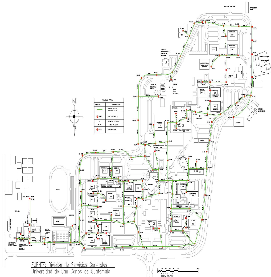
Figura 4. Plano que ubica nuevo sistema de canalizaciones con 2 tuberías unidas con las cajas de registro para MANEJO y para INTERCONEXIÓN distribuidas en todo el Campus Central, zona 12 de la Ciudad Universitaria.
