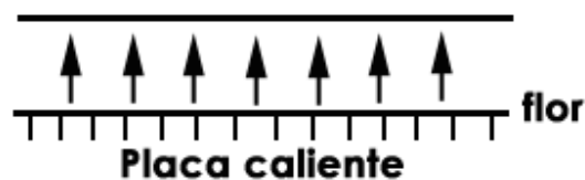
Figura 70 Esquema planchas de secado al vacío (finvac)
