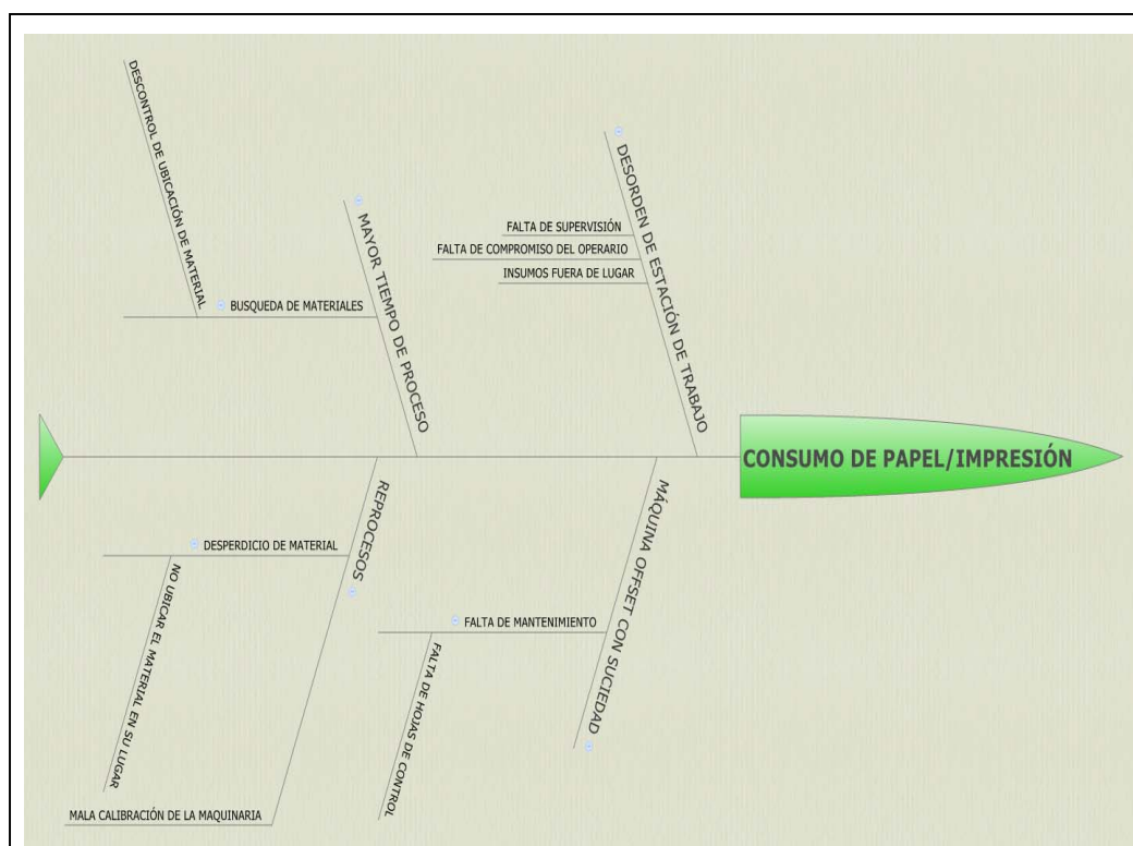
Figura 16. Diagrama causa-efecto en el Proceso de impresión Fuente: Investigación propia
