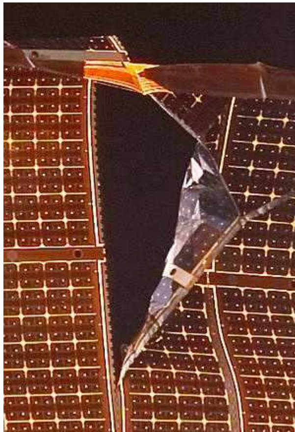
Figura 13. Daño por exceso de temperatura
