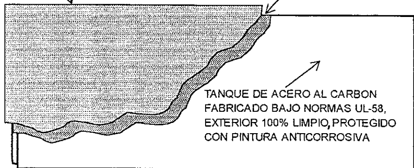
ELEVACIÓN DE TANQUE ENCHAQUETADO
