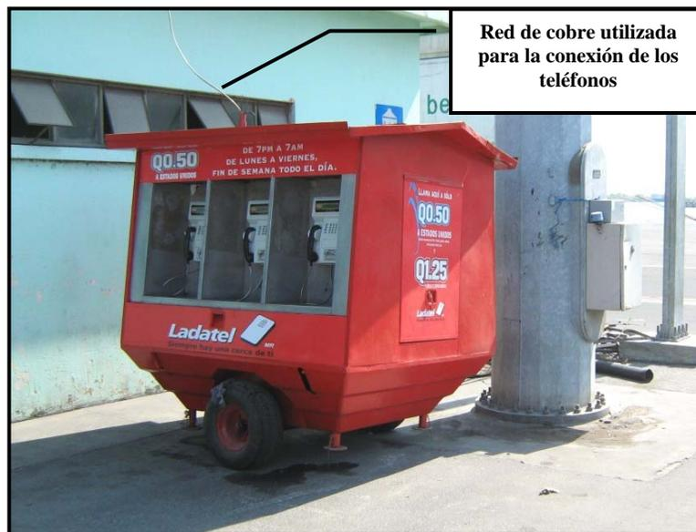
Posee un compartimiento interno que va de un extremo a otro en su parte más larga, justo por en medio de la unidad, de 0.75 mts de ancho por 1.20 mts de alto y 1.85 mts de largo, el cual puede ser utilizado como una pequeña bodega de repuestos, herramientas, alcancías, equipo para remolcar la unidad, etc. Este espacio puede ser utilizado además para colocar un banco de baterías en caso fuera necesario, para alimentar el equipo que recargue las baterías de los aparatos.
