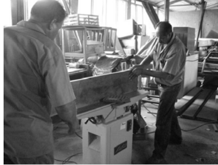
Operación de canteado de las tablas y tablonés.
