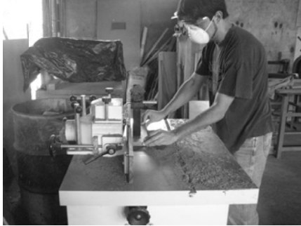
Elaboración de molduras en las piezas de madera.
