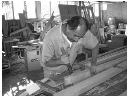
Operación de tallado de las espigas de las piezas.
