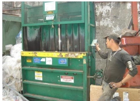
Figura 9. Prensa para compactar sólidos
