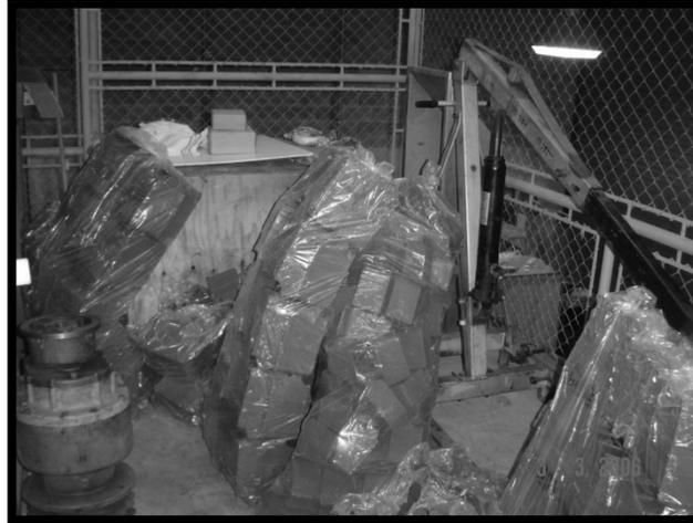
En esta fotografía se ve claramente que los materiales y productos se aíslan del polvo y humedad únicamente con una bolsa plástica; método no recomendable para la protección y conservación de los materiales; además que no se ve ninguna etiqueta que los clasifique e identifique.
