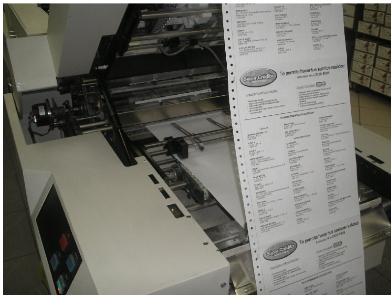
Figura 63. Ajuste de papel en ensobradora
