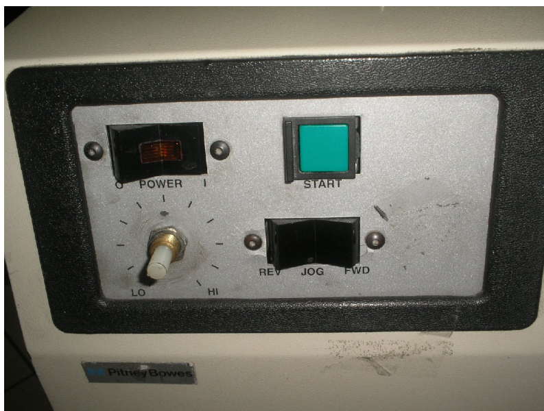
Figura 61. Tablero de alimentación para cortadora
