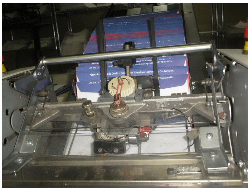
Figura 70. Perilla de ajuste en bandeja de sobres
