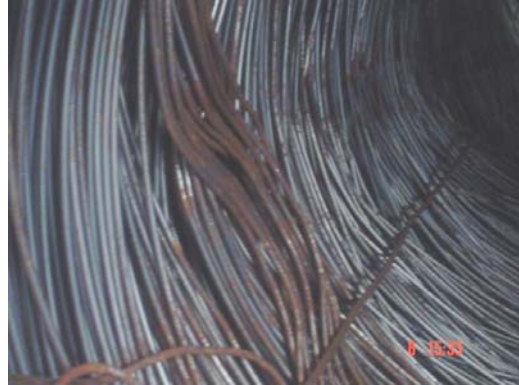
Figura 92. Defectos por mal manejo de materia prima
