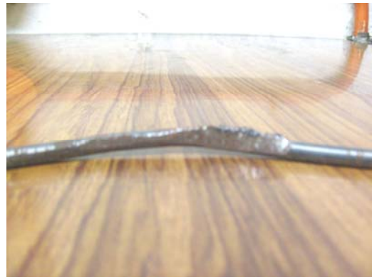
Figura 92. Defectos por mal manejo de materia prima
