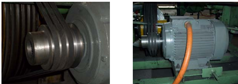
Figura 23. Aumento de diámetro en poleas del motor para incrementar la capacidad productiva de la sección de espigado
