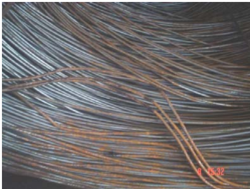
Figura 92. Defectos por mal manejo de materia prima
