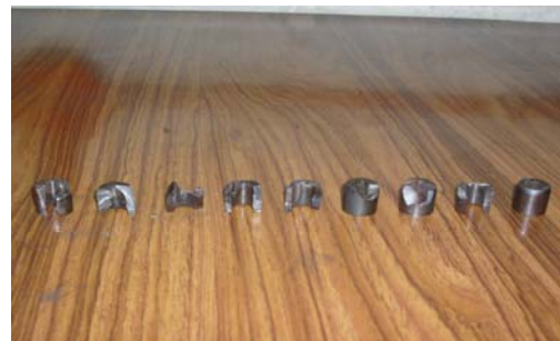
Figura 94. Dados quebrados por materia prima defectuosa
