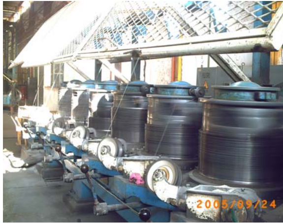
Figura 16. Pasos de máquina trefiladora que experimenta movimiento radial
