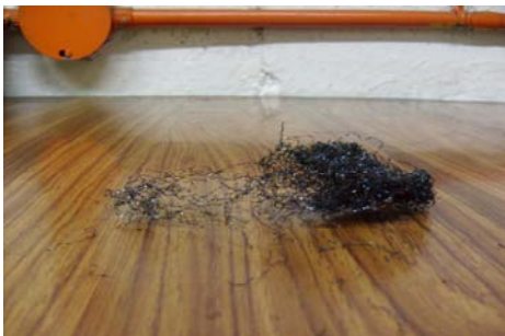
Figura 93. Viruta por mal acabado del dado
