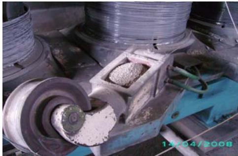
Figura 61. Lubricación en el proceso de trefilado
