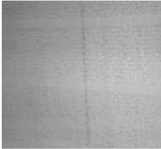
Figura 15. Toalla con hilo incrustado de color oscuro
