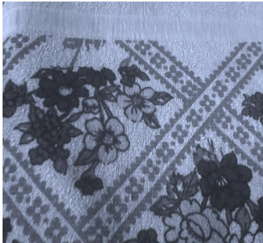
Figura 19. Toalla con estampado defectuoso
