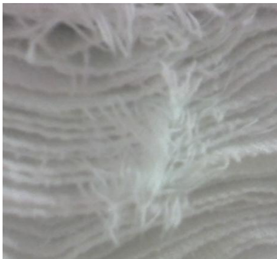
Figura 13. Toalla con exceso de rizo en la orilla
