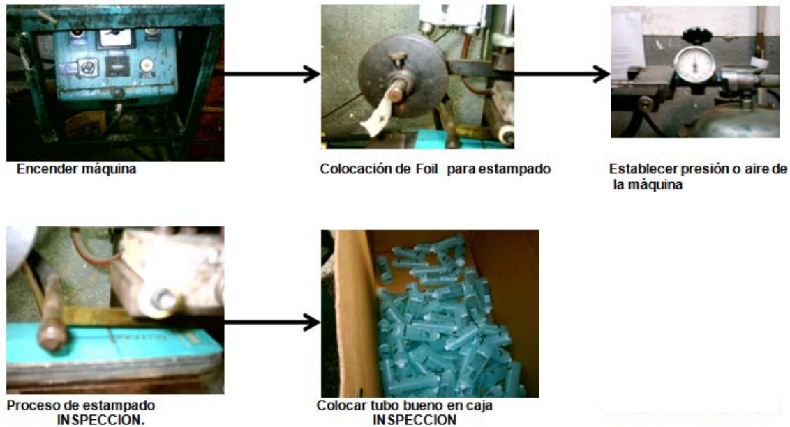
Figura 14. Diagrama del proceso de fabricación de la máquina Estampadora
