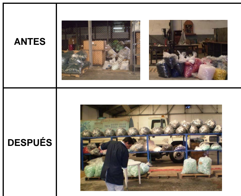
Figura 59. Antes y después de la ubicación de tapas plásticas
