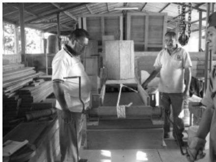
Figura 13. Ensayo de carga rodante
