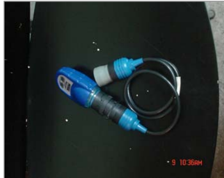
Figura 9. Detector electrónico portátil para la detección de fallas mecánicas.
