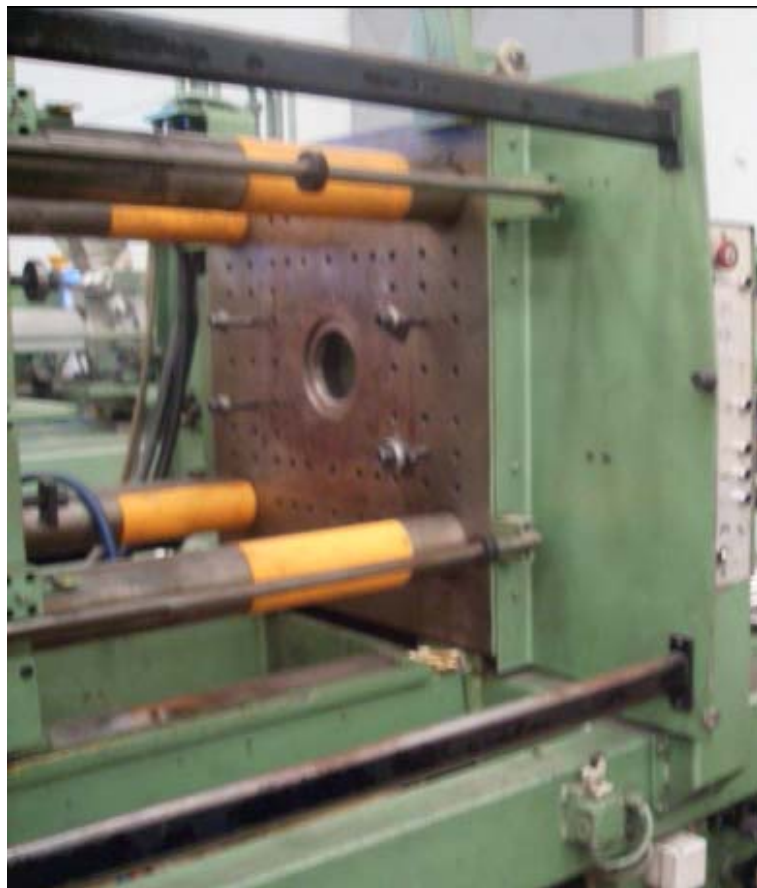
Figura 24. Placa de máquina inyectora donde se coloca molde
