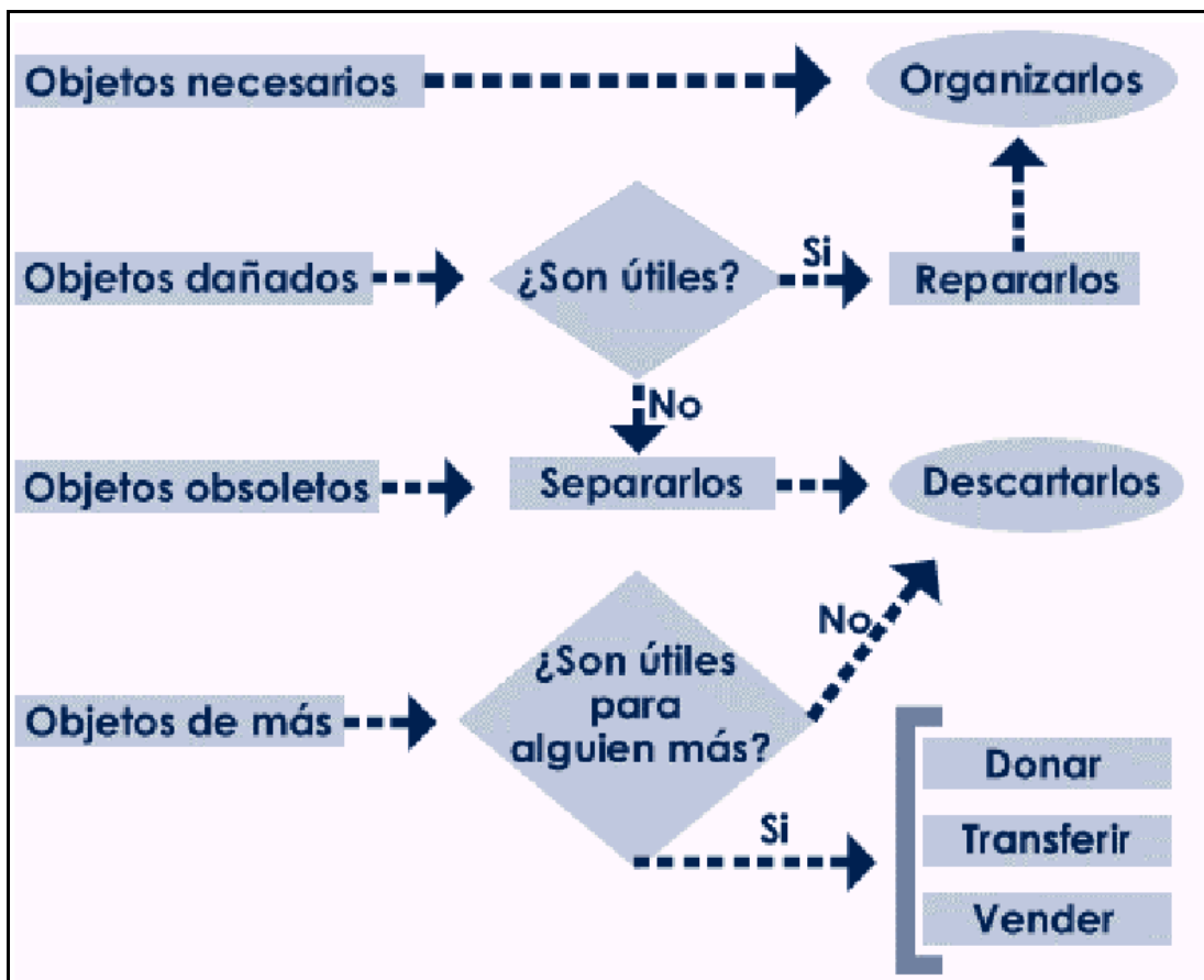
Figura 63. Diagrama de flujo para la clasificación del área de producción.
