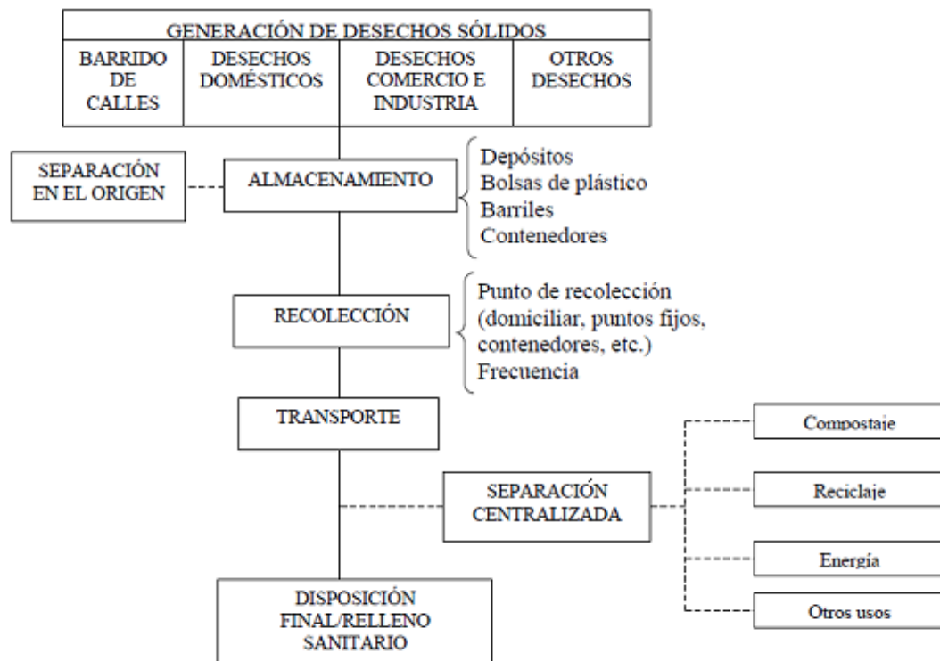
Figura 5. Elementos físicos del sistema de manejo de residuos sólidos
