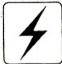
**g. Lámpara de aviso de la temperatura del aceite de la transmisión automática**
