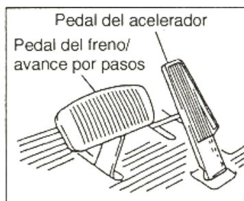
El avance por pasos, requiere el movimiento coordinado del pedal de freno/avance por pasos, y del pedal del acelerador.
