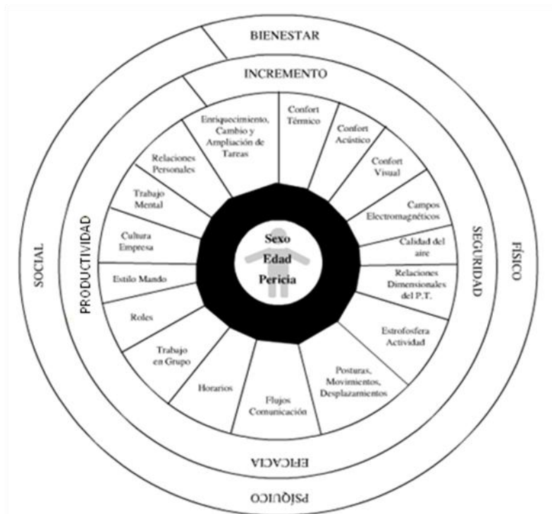
Figura 3. Variables mínimas a considerar en el diseño de un puesto de actividad para diferentes operarios.
