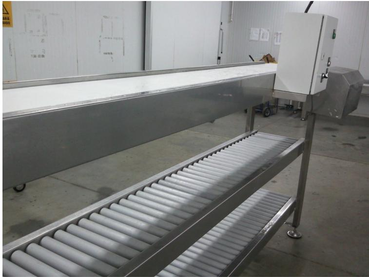
**Figura 18. Banda transportadora mejorada ergonómicamente**
