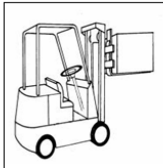
Figura 4. Montacargas con contrapeso en la parte trasera.
