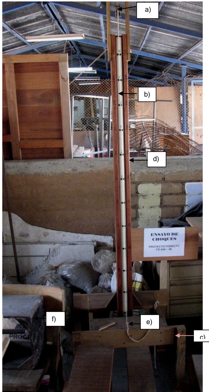
Figura 15. Partes del equipo para ensayo de choques
