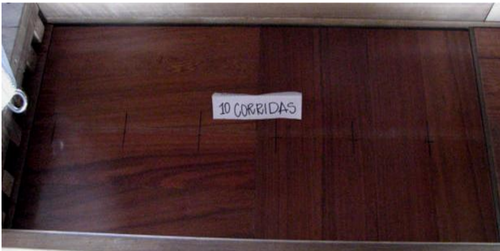
Figura 55. Aspecto de la probeta de la especie Manchiche después de pasarse el carrillo, durante el ensayo de carga rodante
