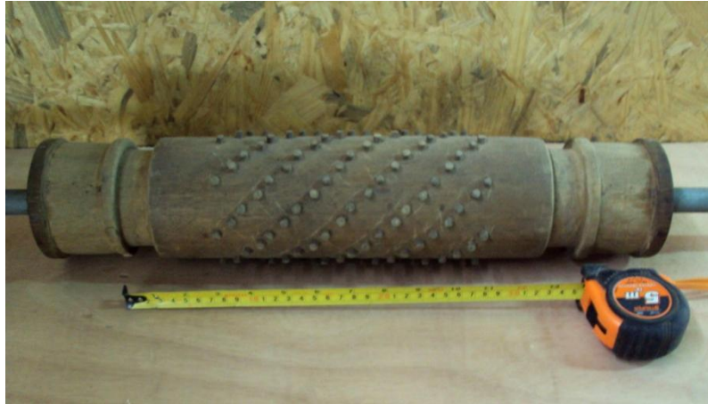
Figura 5. Rodillo dentado de madera dura para el ensayo de carga concentrada con movimiento
