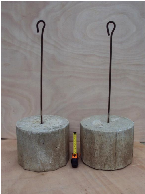
Figura 6. Cargas de 45kg, cada una, utilizadas en el ensayo de carga concentrada con movimiento
