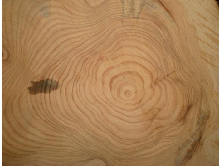
Figura 73. Anillos anulares que constituyen la madera
