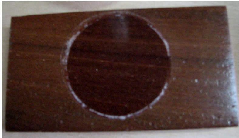
Figura 62. Probeta de la especie Manchiche después del ensayo ataque de productos domésticos con aplicación de amoníaco al 10%
