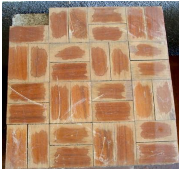
Figura 66. Probeta M – 1 de la especie Manchiche después del ensayo control de encolado 150 días
