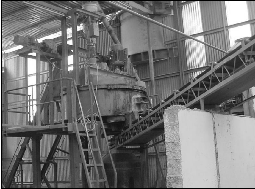
Figura 44. Mezcladora tipo planetaria
