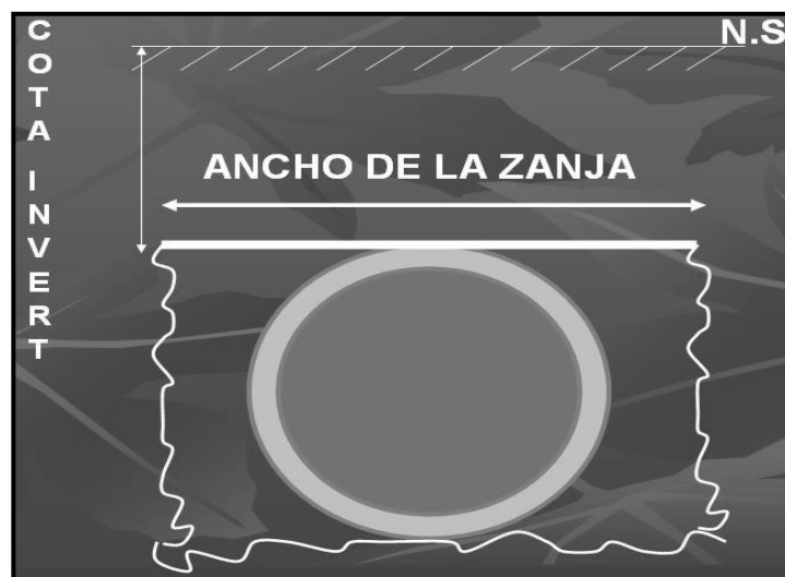
Figura 60. Instalación correcta de una tubería de concreto
