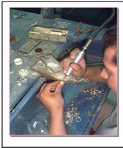
Figura 2. Preparación de piezas para la elaboración de moldes
