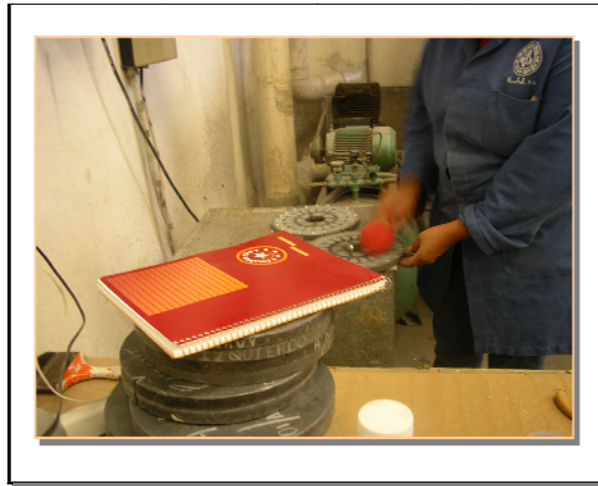
Figura 4. Esparcir mica o talco en el molde con el contenedor
