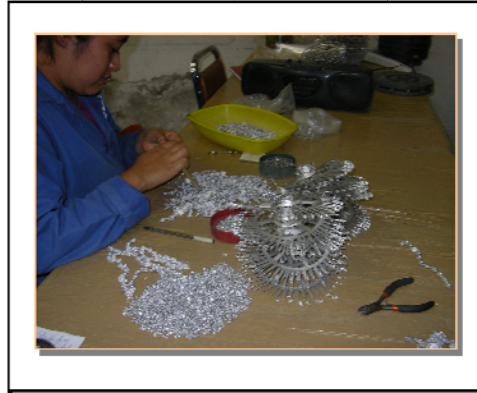
Figura 10. Quitar exceso de muescas, filos y rebabas
