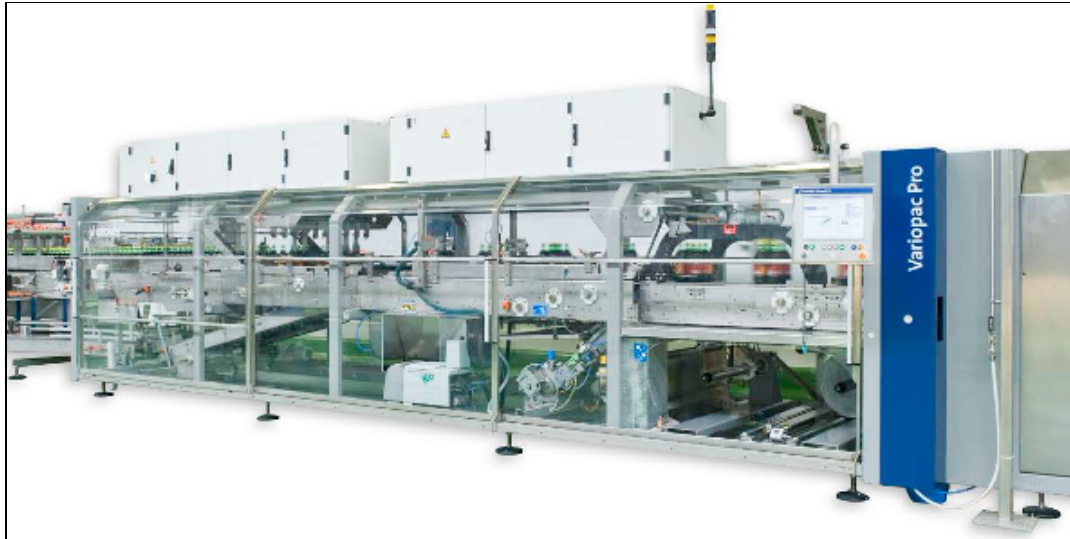
Figura 11. Armadora de paquetes de producto terminado (empacadora)
