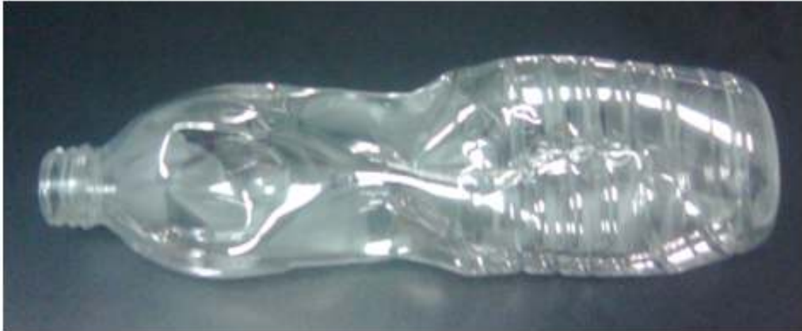
Figura 15. Defectos: envase deformado
