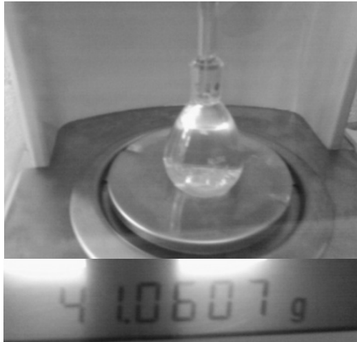
Figura No. 6 Peso picnómetro con solución.
