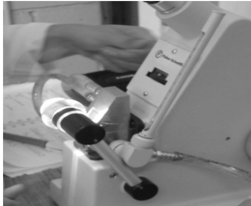
Figura No. 15 Luz del refractómetro.
