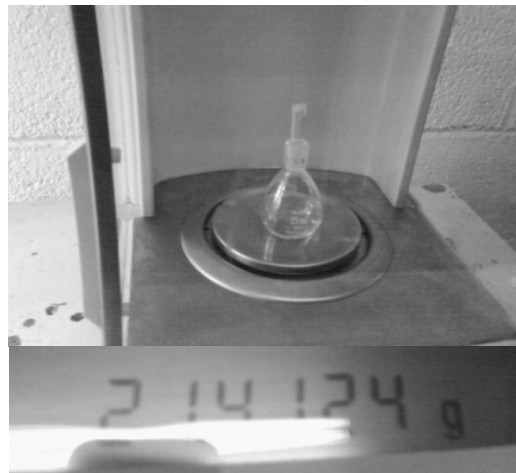
Figura No. 4 Peso picnómetro sin solución.
