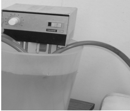
Figura No. 9 Conexión de mangueras del refractómetro.
