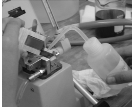
Figura No. 12 Limpieza del cristal del refractómetro.
