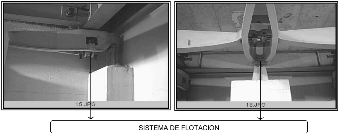
Figura 30. Sistema de flotación en básculas fijas mecánicas
