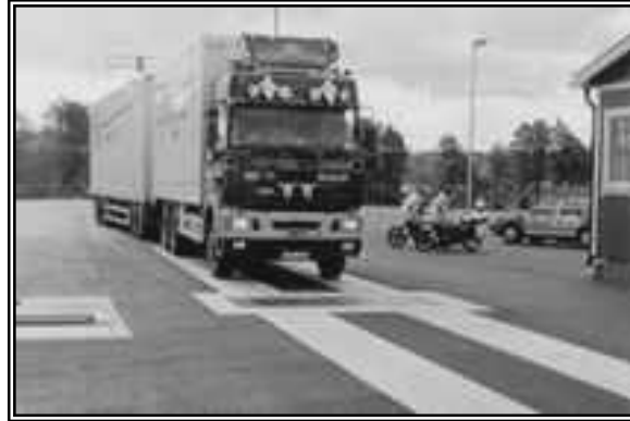
Figura 50. Sistema de pesaje electrónico, plataforma para pesaje por eje
