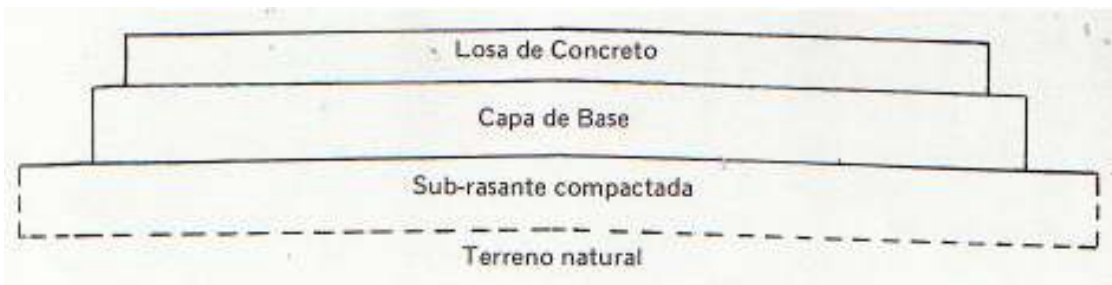
Figura 2. Estructura del pavimento rígido
