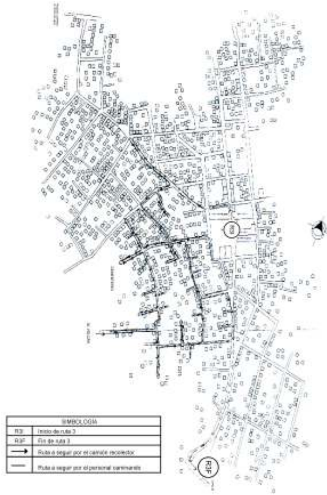
Figura 6. Descripción de rutas del camión recolector en el municipio de Santa María de Jesús
