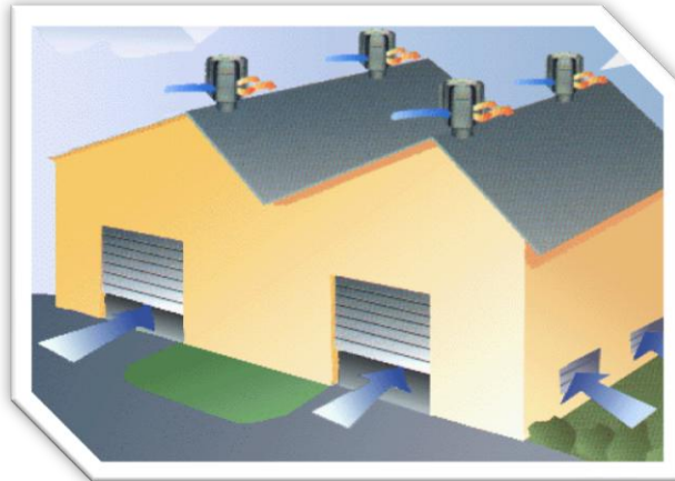
Figura 12. Sistema de ventilación industrial
