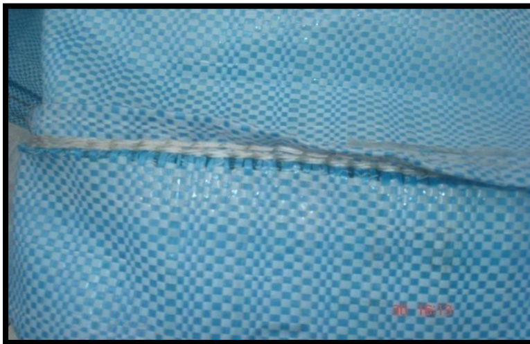
Figura 9. Rotura en costuras de jumbo por tela de bajo gramaje
