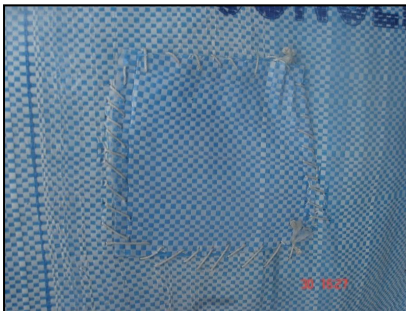
Figura 38. Verificación del parcheo
