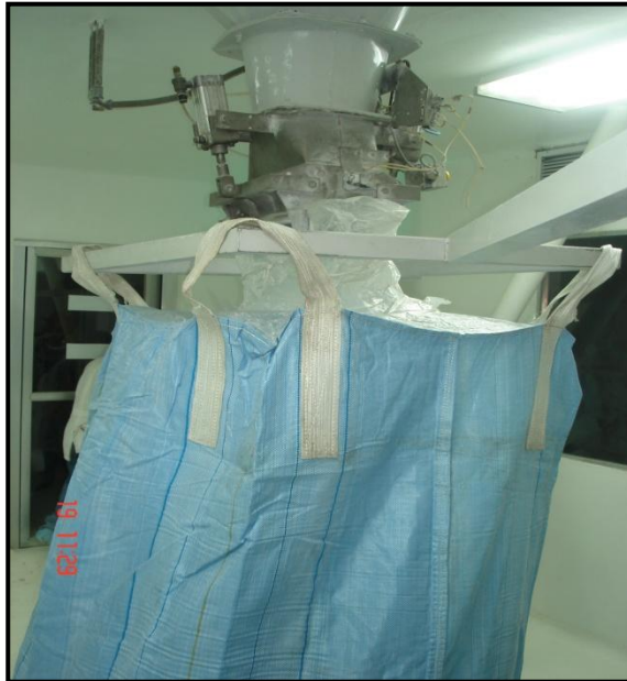
Figura 12. Jumbo al llenarse en tolva de descargue
