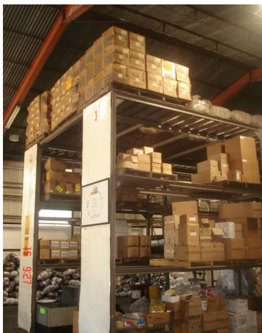
Figura 34. Mal apilamiento de cajas en estanterías
