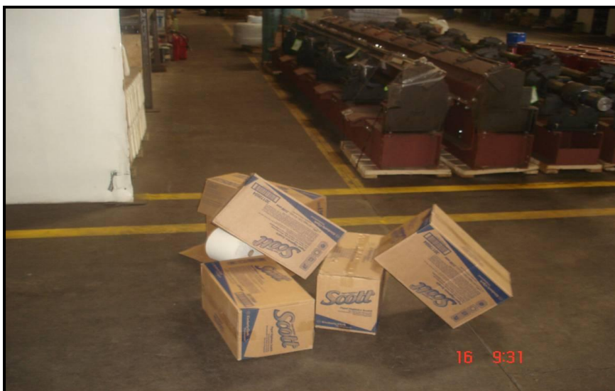
Figura 33. Cajas que obstruyen pasadizos
