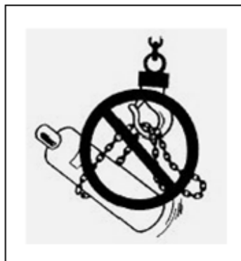
Figura 29. Indicador de prohibición de utilización de cadenas o cables para transportar botellas de gas
