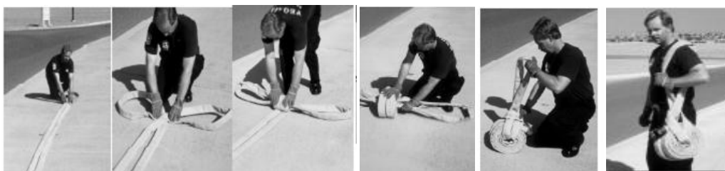
Figura 53. Enrollado con dos conexiones paralelas y autocierre
